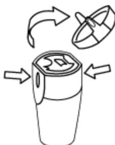
3. Insérez la pile de type N-cell dans le stylet Mimio Capture Kit.
