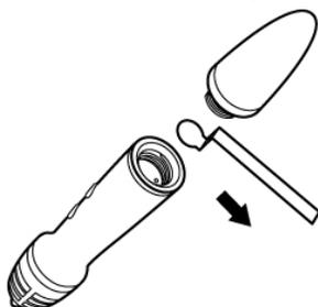
3. Remplacez la partie supérieure sur le corps du stylet et tournez-la dans le sens des aiguilles d'une montre pour l'attacher.
