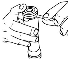
2. Appuyez sur le bouton sur le côté du stylet et séparez la partie supérieure du stylet du corps de celui-ci.
