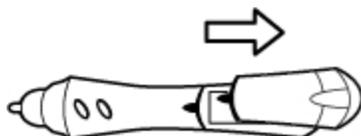
2. Placez la pile AA dans le compartiment à piles.
