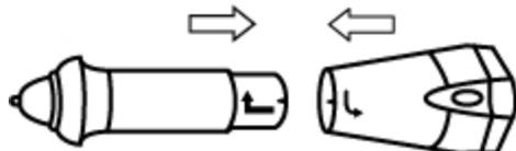
7. Pressez les deux parties du stylet l'une contre l'autre et faites-les tourner pour les verrouiller.
