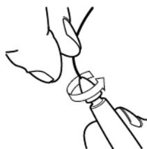
2. Placez la pointe de stylet supplémentaire sur le stylet et tournez dans le sens des aiguilles d'une montre pour fixer le cordon.
