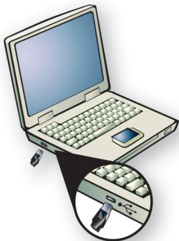
Conecte un Adaptador USB inalámbrico en un Puerto USB disponible. Si no hay espacio suficiente para que un Adaptador USB se conecte a un puerto USB, debe utilizar el cable de extensión USB con el Adaptador USB para permitir la conexión USB.
