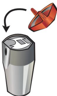
Coloque un tapón de color adecuado en la pluma Stylus hasta que encaje perfectamente. Alinee el tapón de color para que el resorte haga contacto con la batería.
