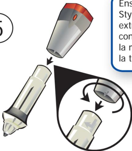
Ensamble nuevamente la pluma Stylus alineando la flecha en el extremo posterior de la pluma con la flecha en el tubo claro de la misma, luego empuje y gire la traba.
