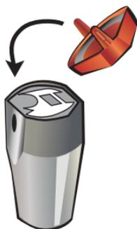
Placez le couvercle de couleur approprié sur le stylet en accrochant les ergots. Alignez le couvercle de couleur de façon à ce que le ressort soit en contact avec la pile.
