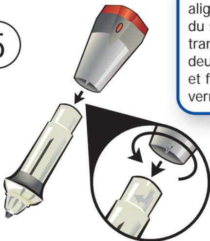
Réassemblez le stylet en alignant la flèche sur l'extrémité du stylet avec celle sur le tube transparent, puis pressez les deux parties l'une contre l'autre et faites-les tourner pour les verrouiller.
