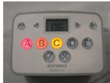
写真4 MimioVoteは、出題する問題に応じてボタンの表示を教師が切り替えられる。例えば、A、B、Cの3つの選択肢から1つを選ばせる場合は、写真のように該当するボタンだけを光らせる。生徒がボタンを押して回答すると、その状況がリアルタイムに集計される
