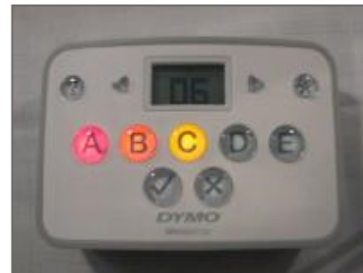
写真4 MimioVoteは、出題する問題に応じてボタンの表示を教師が切り替えられる。例えば、A、B、Cの3つの選択肢から1つを選ばせる場合は、写真のように該当するボタンだけを光らせる。生徒がボタンを押して回答すると、その状況はリアルタイムに集計される [画像のクリックで拡大表示]
